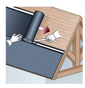
2. Entfernung der Schutzfolie vom Klebestreifen und bündige Verlegung der zweiten Rolle (ebenso mit Klebeband nach oben), damit diese mit der ersten Rolle verklebt werden kann
