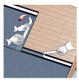
5. Verwendung vonButylband (bauseits)zur Befestigung derQuer-Überlappung
