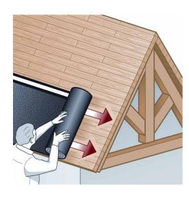
1. Verlegung der ersten Bahn beginnend an der Trauflinie (Klebeband nach oben)
