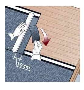
4. Quer-Überlappung: Entfernung von ca. 10 cm des Monofilaments (= schwarzes Wirrgelege), sodass nur noch die reine Dachunterspannbahn verbleibt
