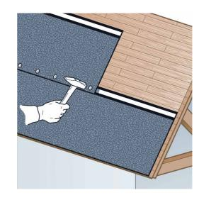
3. Zusätzlich empfehlen wir eine Fixierung durch z. B. Dachpappennägel bzw. Heftklammern (bauseits)
